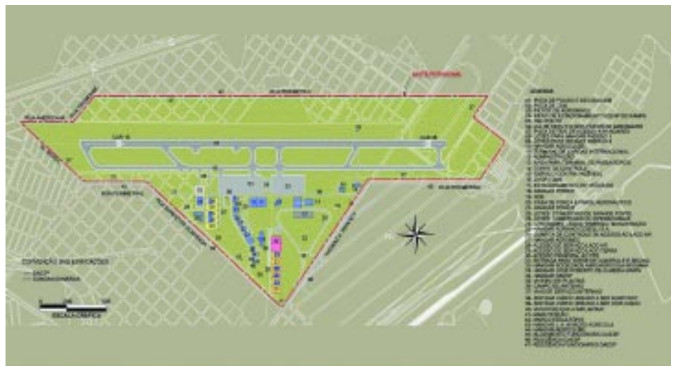
Implantação inicial da pista de 2.400 m
